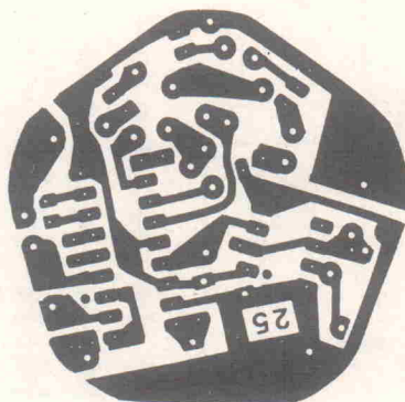
Platinen-Layout für die Ansteuerungs-Platine
